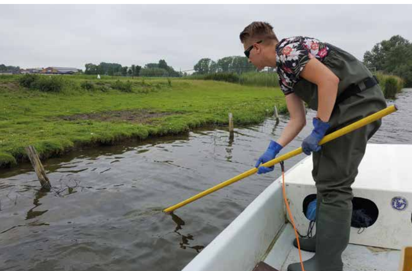
Voor het bemonsteren van de visstand is gebruik gemaakt van het elektrovisapparaat.
