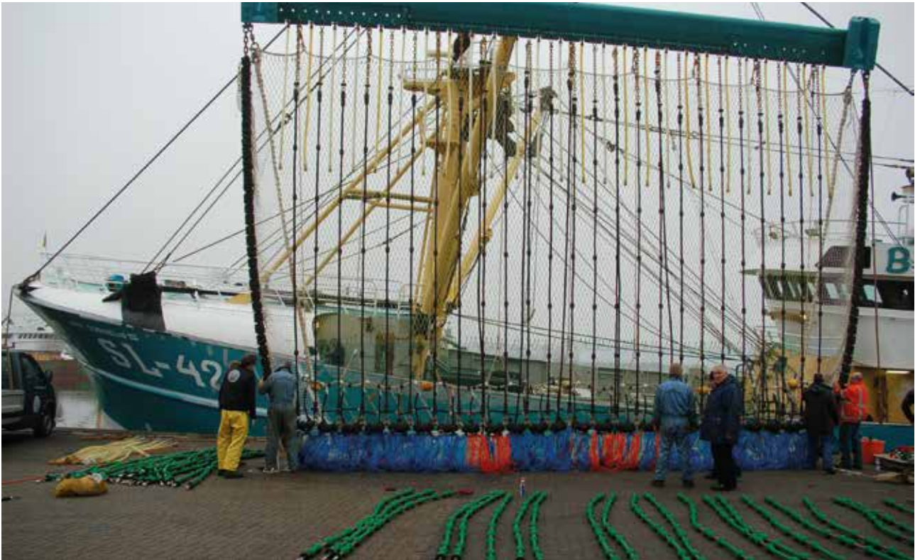
De komende tijd wordt onderzocht of door aanpassingen aan de elektrische pulsling selectiever kan worden gevisst.
