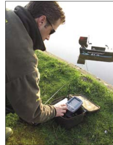
Een voerboot met draadloze dieptemeter stelt je in staat om aan de kant te zien wat er onder de voerboot gebeurt.
