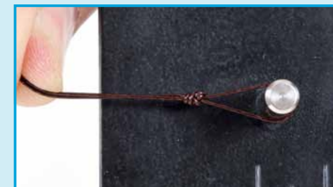
25 Opnieuw geldt: goed aantrekken; aan beide uiteinden tegelijk, zodat de coating niet los raakt.
