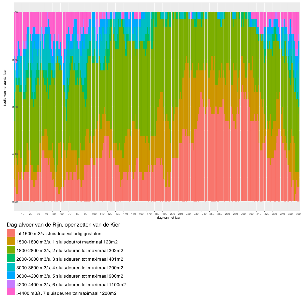
Figuur 3.3: Openstelling van de sluizen in de Haringvlietdam zoals die gegeven de dag-afvoer van de Rijn volgens het Kierbesluit zou hebben plaatsgevonden in de periode 1989-2014. Per dag van het jaar wordt het aantal dagen voor elk van de 8 openstellingsopties weergegeven (uitgedrukt als fractie van het totaal aantal dagen per datum in de periode 1989-2014 (26)). De 8 openstellingsopties zijn 0 = volledig gesloten, 1 = 1 sluisdeur tot maximaal 123 m 2 , 2=2 sluisdeuren tot maximaal 302 m 2 , 3 = 3 sluisdeuren tot maximaal 401 m 2 , 4 = 4 sluisdeuren tot maximaal 700 m 2 , 5 = 5 sluisdeuren tot maximaal 900 m 2 , 6 = 6 sluisdeuren tot maximaal 1100 m 2 , 7 = 7 sluisdeuren tot maximaal 1200 m 2 .
