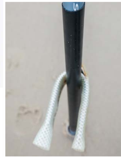
Op het onderste hengeldeel heeft Wouter met behulp van talkpoeder een stuk binnenband bevestigd voor extra grip.
