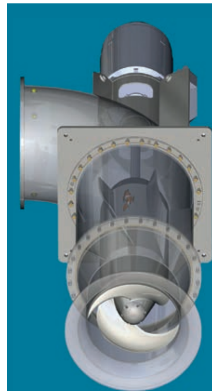
Doorsnede van een langzaam draaiende, visvriendelijke pomp.
