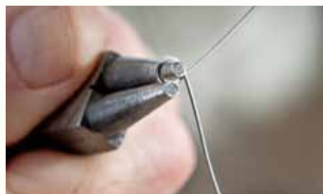
Stap 2: vouw nu aan een uiteinde een mooi rond oog met een tang met ronde punten.
