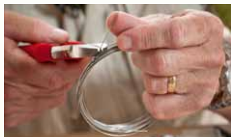
Stap 1: knip een stuk staaldraad (0,6 - 0,8 mm dik) van zo'n 20 cm af.
