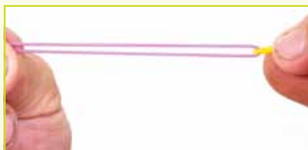
Zorg dat het elastiek tot zo'n 10 cm voorbij het oogje van de connector loopt en leg het elastiek nu dubbel.
