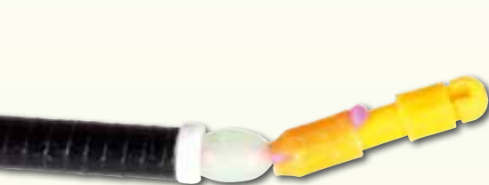
Stap 1: Zaag de (holle top) af op de juiste lengte en monteer een manchetje.
