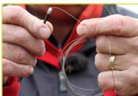
Stap 2: Steek nu het ijzerdraad (met de lus voorop) via het manchetje in en door het topdeel.
